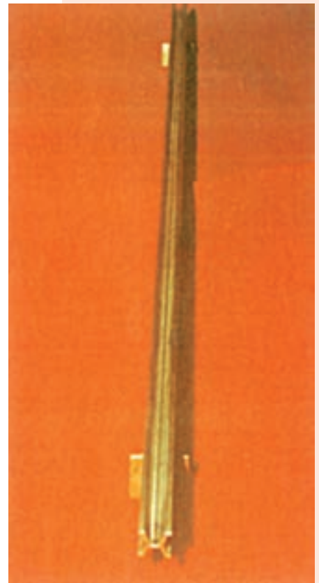
شکل ۱-۴ میله‌ی استاندارد طول از جنس پلاتین - ایریدیم که در موزه ای نزدیک پاریس نگهداری می‌شود.
