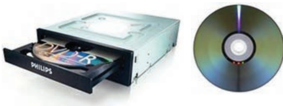
شکل ۱۶-۲- دیسک نوری و گرداننده آن
