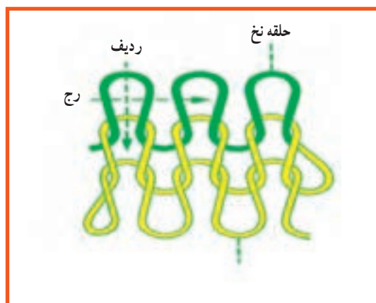
شکل ۸-۹- ساختار پارچه حلقوی پودی
