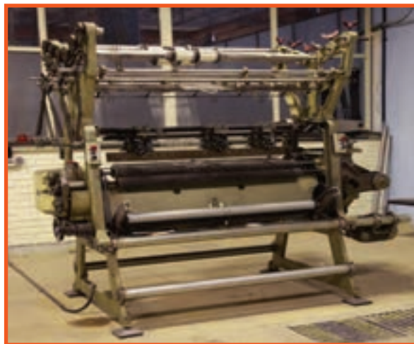
شکل ۹-۱۰- ماشین بافندگی حلقوی تاری
