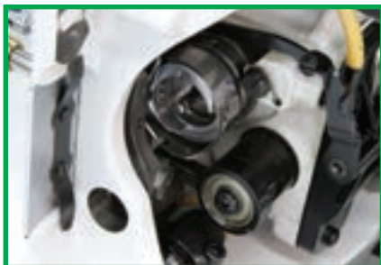
شکل ۶-۸ - ماسوره، ماکو و قاب ماکو
