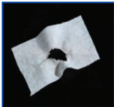
شکل ۴-۵ اثر اسیدکلریدریک بر پارچه ویسکوز ریون
