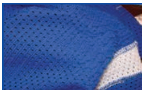
شکل ۱۱-۵ ایجاد پُزدانه در پلیور از جنس آکرلیک
