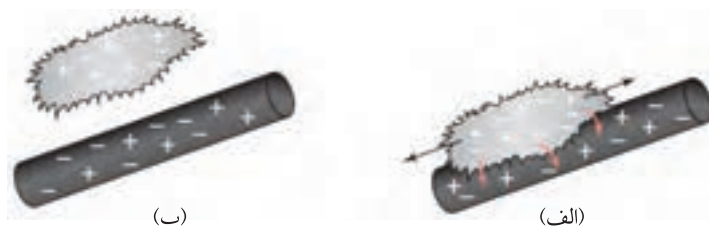
شکل ۲-۴۳ گرمای حاصل از مالش دو جسم به یکدیگر، الکترون‌ها را از اتم‌های یک جسم جدا و به جسم دیگر منتقل می‌کند.
