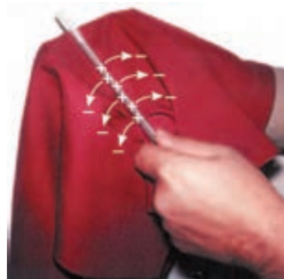
شکل ۲-۸ بر اثر مالش الکترون‌ها از میله شیشه‌ای به پارچه‌ی ابریشمی منتقل می‌شوند.
