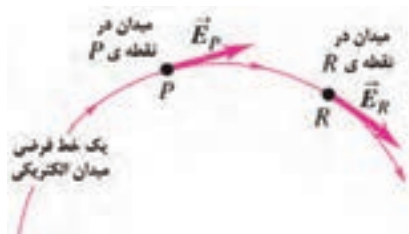
شکل ۲-۳۰ جهت میدان الکتریکی در هر نقطه بر خط میدانی که از نقطه می‌گذرد مماس است.
