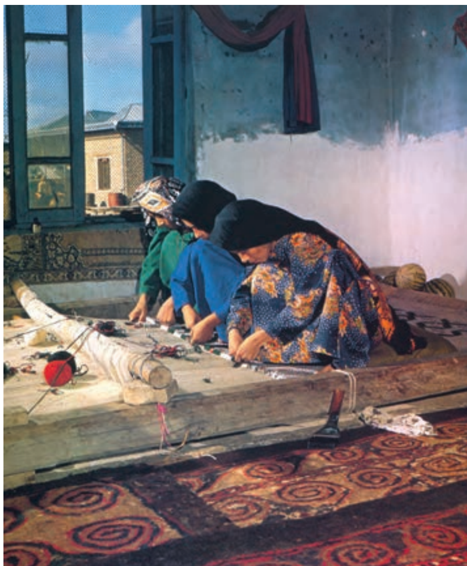
تصویر ۲-۱۲- تصویری از یک دار زمینی در حین انجام کار (افقی)
