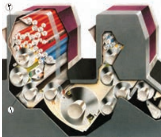
شکل ۲-۶- سیستم‌های شست‌وشوی اتوماتیک. ۱- سیلندرها ۲- نوردها
