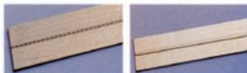
شکل ۷-۵- ورق‌های فلزی پرفراژکاری، قابل نصب روی سیلندر لاستیک با نوارهای خط‌زنی و پرفراژ که روی ورق چسبانده می‌شوند.
