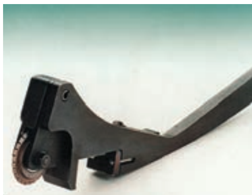
شکل ۵-۶- ابزار پرفراژکاری شامل چرخ پرفراژ طولی و تیغه پرفراژ عرضی
