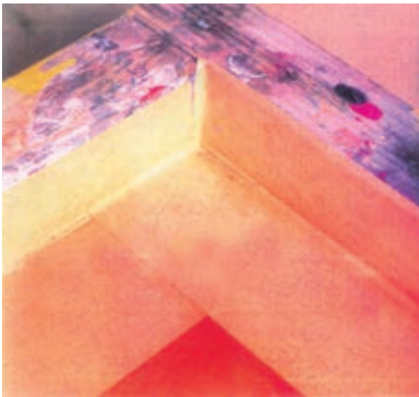
شکل ۱۱-۳۷- روش چسب زدن
