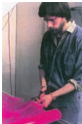
شکل ۱۱-۱۴- برش فیلم استنسیل
