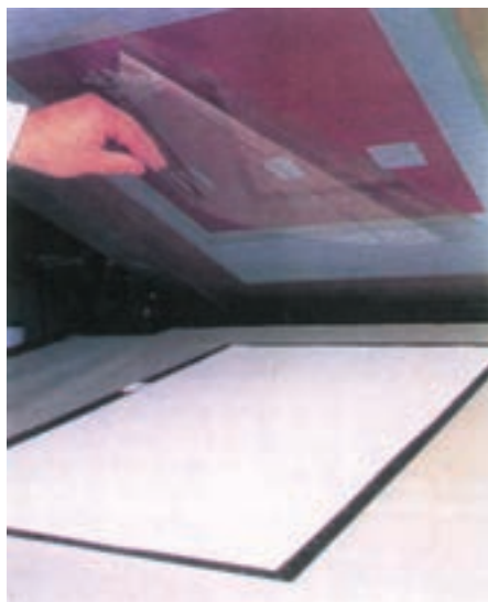
شکل ۱۱-۱۰- برداشتن لایه شفاف پس از عمل انتقال لایه ژلاتینی به سطح توری
