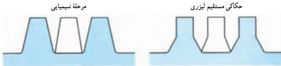
شکل ۹-۴- مقایسه ایجاد نقش برجسته یک پلیت چاپ فتوپلیمر تولید شده در یک مرحله فتوگرافیک/شیمیایی با پلیت (لاستیکی) حکاکی شده توسط لیزر
