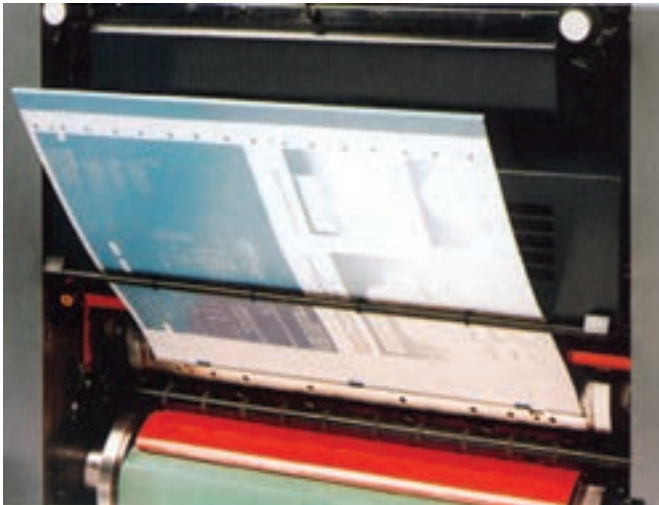
شکل ۴-۲۰- تعویض اتوماتیک پلیت
