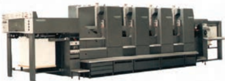
شکل ۴-۲۲- سیستم تمام اتوماتیک تعویض پلیت (مالتی پلیت هایدلبرگ)
