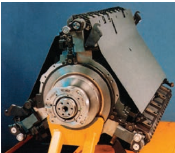
شکل ۴-۱۷— سیلندر انتقال سه برابر (حداکثر اندازه‌ی ورق)
