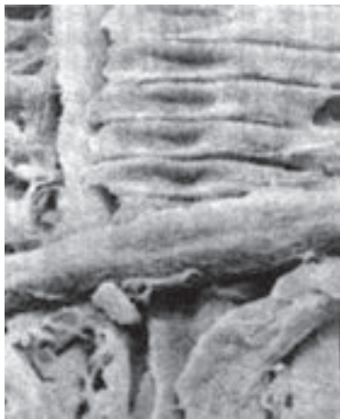
شکل ۱-۳- خمیر چوب آسیا شده با بزرگ‌نمایی ۴۲۰ برابر
