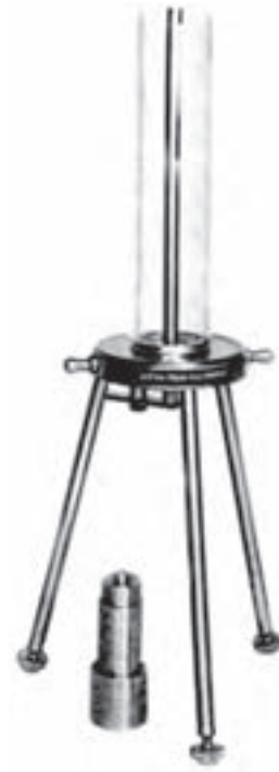
شکل ۲۴-۲- دستگاه سنجش ویسکوزیته (ویسل، زیومتر لوری)
