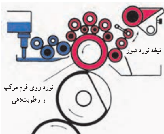
شکل ۱۰-۲- انتقال محلول رطوبت‌دهنده از طریق نورد مرکب
