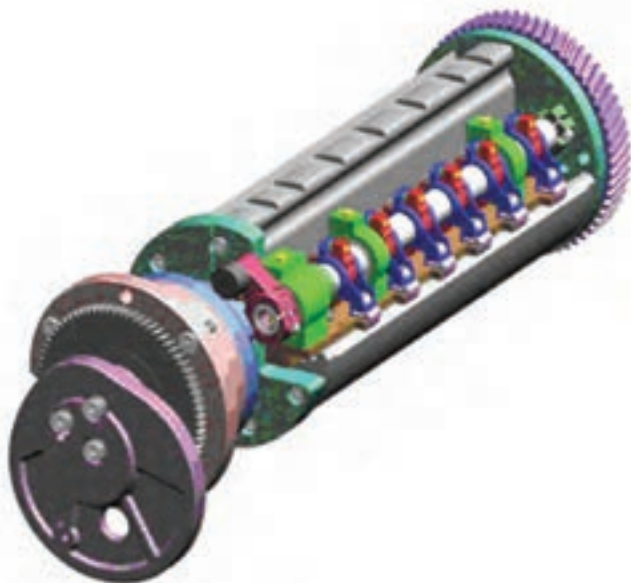
شکل ۲-۲۳- سیستم پنجه سیلندر فشار (چاپ) و اجزای تشکیل‌دهنده‌ی آن
