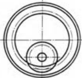
درگیری دو چرخنده داخلی
