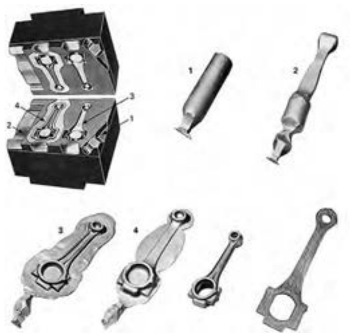
شکل ۱۰-۲- مراحل ساخت یک شاتون بوسیله قالب بسته
