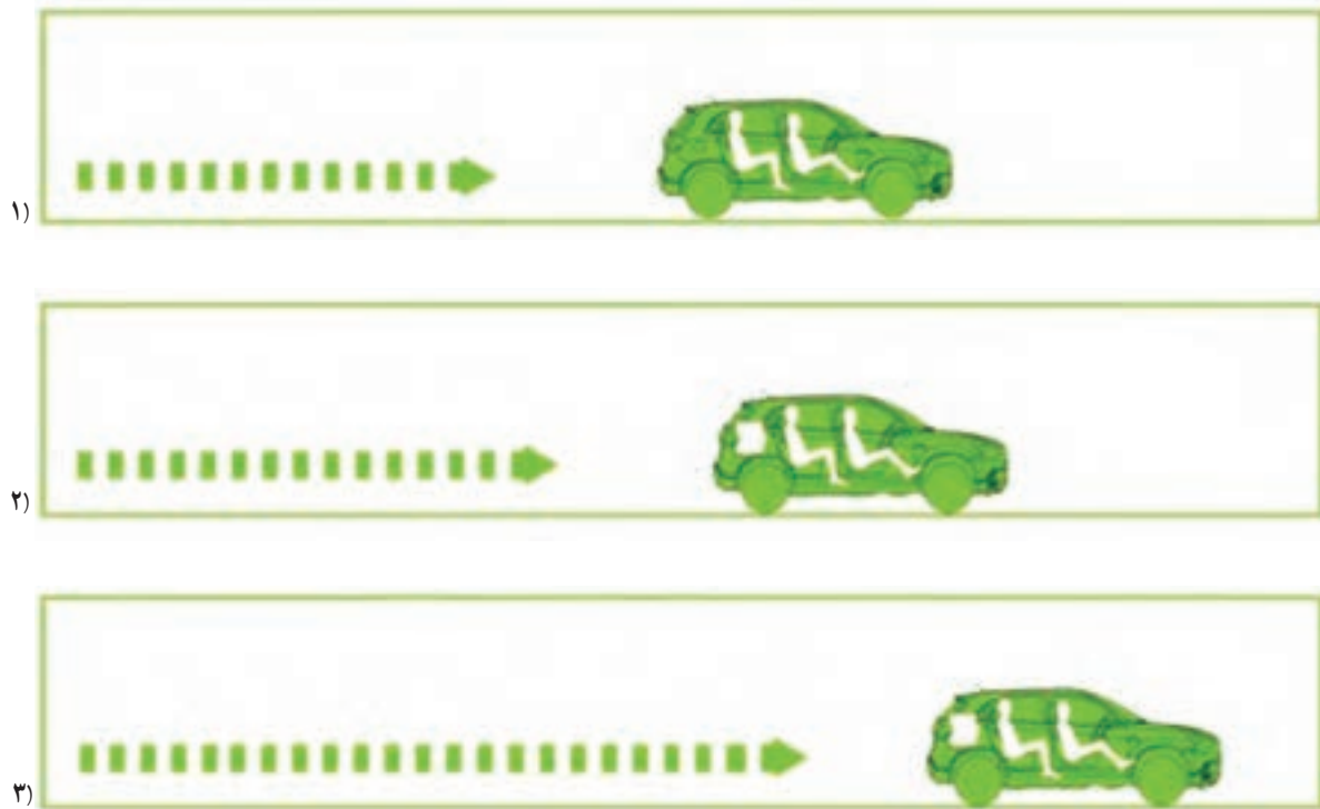
شکل ۱۵-۱۱- نحوه عملکرد سیستم EBD و مقایسه حالت‌های مختلف ترمزگیری
