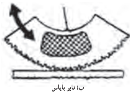
شکل ۵-۱- مقایسهٔ وضعیت شتاب‌گیری و ترمزگیری خودرو با دو نوع تایر بایاس و رادیال
