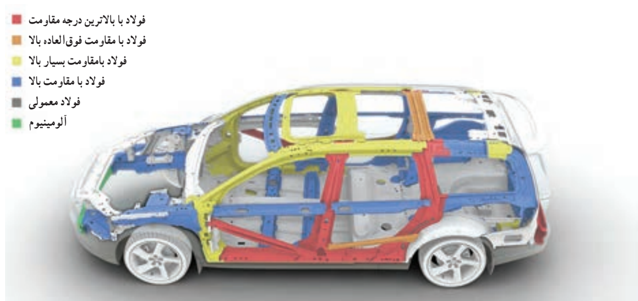
شکل ۱-۱-۱- استفاده از ورق‌هایی با قابلیت انعطاف در قسمت جلو و عقب خودرو و نیز ورق‌هایی با استحکام بالا در اطراف محفظه سرنشین
