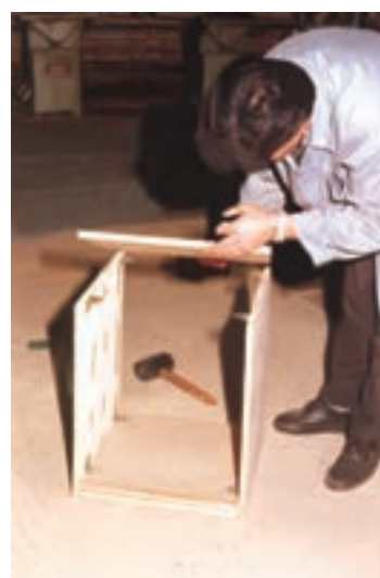
شکل ۲۱-۱۱- استفاده از چکش لاستیکی و چوب
