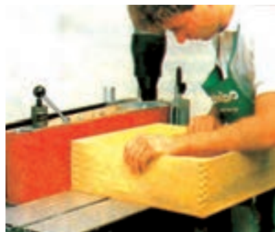
شکل ۶-۱۲- سنباده زدن و پرداخت کردن بدنه جعبه
