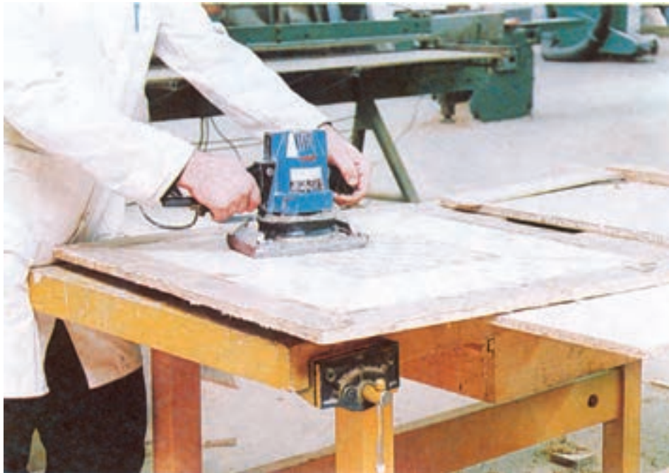
شکل ۱۹-۱۲- نحوه استفاده از دستگاه سنباده لرزشی در عملیات پرداخت کاری
