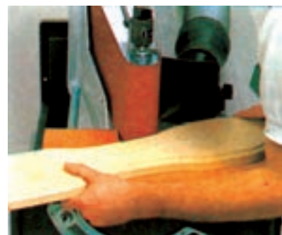
شکل ۷-۱۲- نحوه سنباده زدن قوس‌های مقعر
