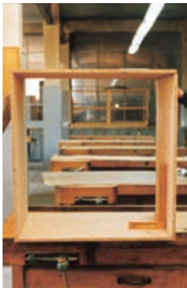
شکل ۱۱-۲۶- کنترل زوایای کار مونتاژ شده
