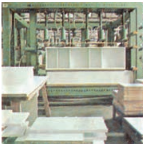
شکل ۲۰-۱۱ قسمت مونتاژ کابینت با تنگ پنوماتیک
