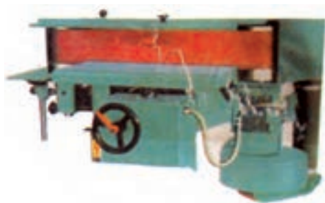
شکل ۱۳-۱۲- سنباده نواری کوچک به اندازه ۱۵۵×۱۸۰ میلی متر
