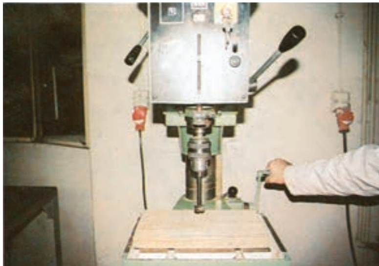
شکل ۹-۳۶- استقرار صحیح صفحه روی میز متحرک دریل ستونی
