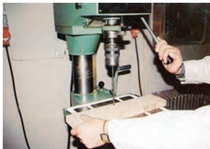
شکل ۹-۵۲ – فرو کردن نیش مرکزی مته در مرکز سوراخ قبل از سوراخکاری
