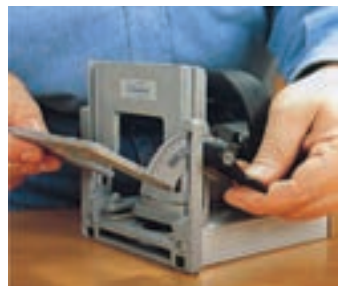
شکل ۹-۱۱۰- نحوه تنظیم زاویه گونیا
