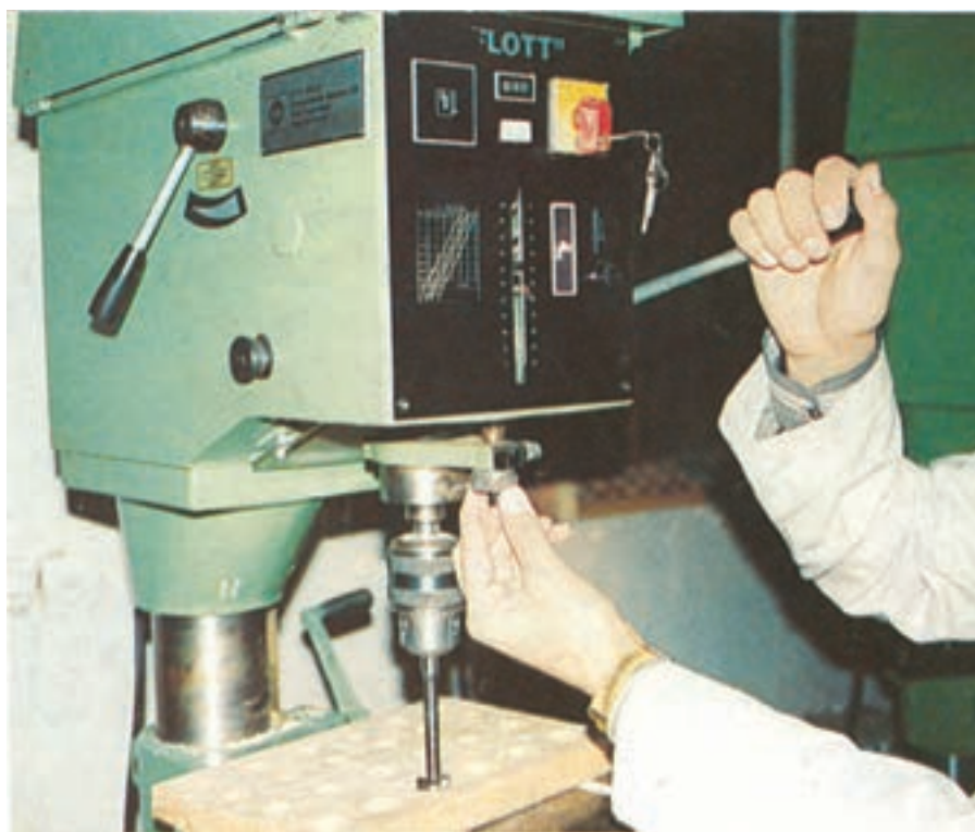
شکل ۲۴-۹- نحوه تنظیم عمق سوراخ در ماشین دریل ستونی
