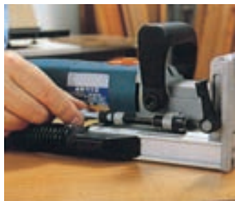
شکل ۹-۱۰۹- نحوه تنظیم عمق تیغه
