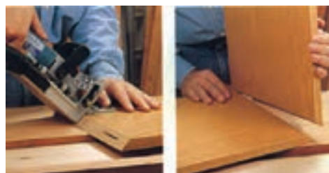
شکل ۹-۱۰۷- اتصال بیسکوییتی در دو صفحه به صورت 45^\circ فارسی
