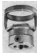
شکل ۹-۶۸- قطعه کمکی کنترل عمق
