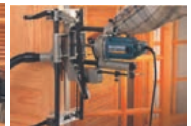
شکل ۷۸-۹- ایجاد شیار عمودی برای قفل مغزی
