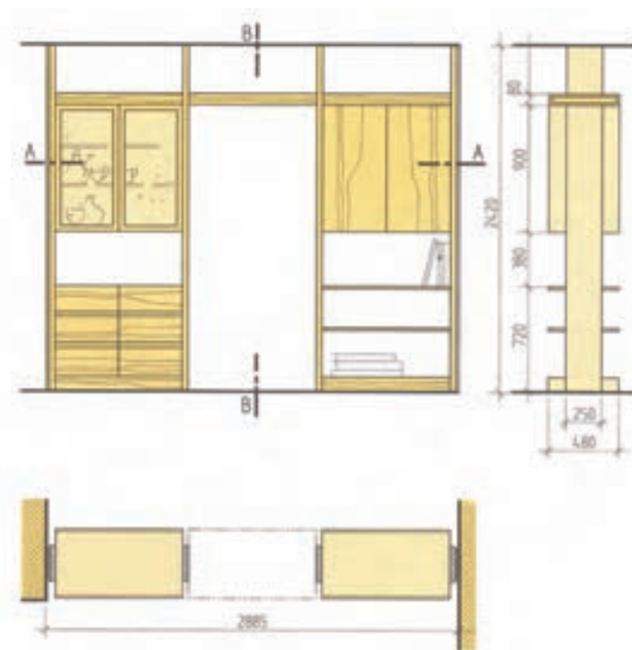
شکل ۵-۴۲- ترسیم نقشه‌ی پلان و نماهای پارتیشن با در برای رفت و آمد به فضای مجاور
