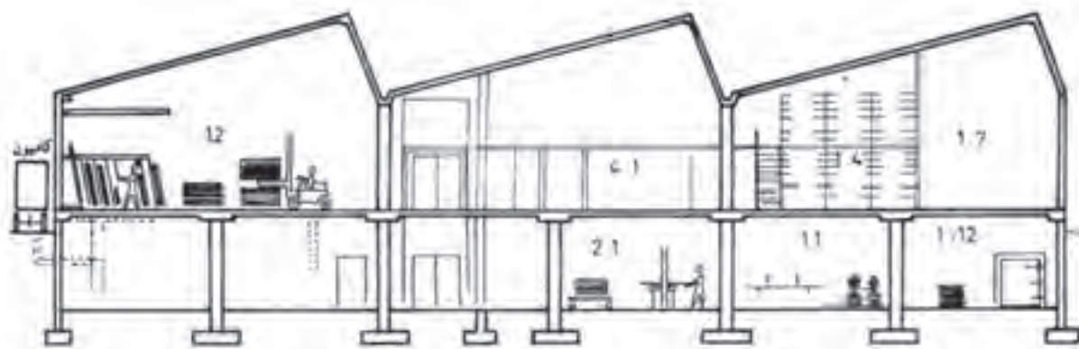
قسمتی از ساختمان کارخانه یا تاق دنده اره‌ای به منظور رسیدن نور کافی به تمام سالن‌ها
