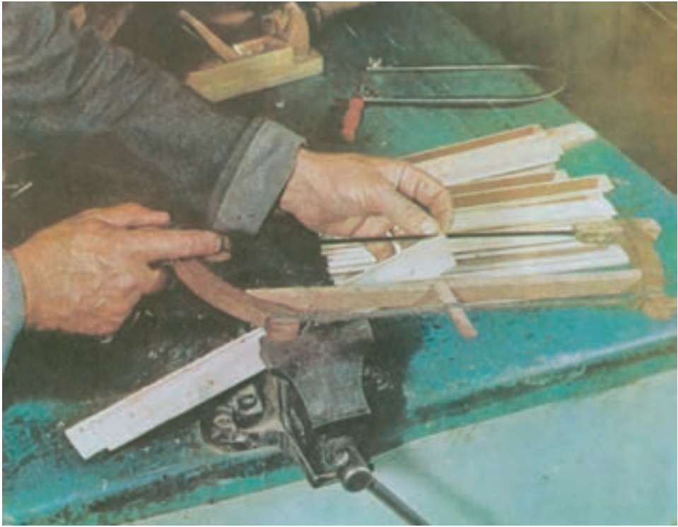
شکل ۱۷-۶- نحوه‌ی برش خاتم آسترشده
