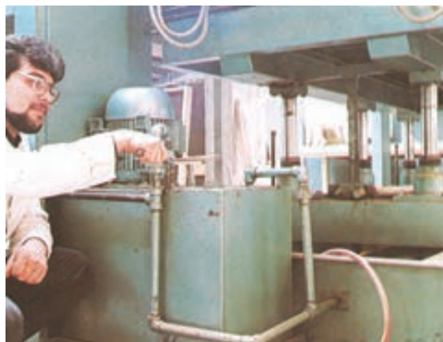
شکل ۷-۱۹- شیر روغن به وسیله‌ی دانشجوی صنایع چوب، در وضعیت بسته قرار داده شده است.
