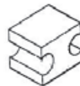
شکل ۸-۳ الف)، نمونه آزمایش کشش عمود بر الیاف
