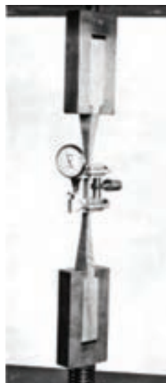
شکل ۲-۸ ج، نمونه کشش موازی الیاف در حال آزمایش، کرنش سنج نصب شده افزایش طول نمونه (کشیده شدن) قبل از شکست را اندازه گیری می کند.
