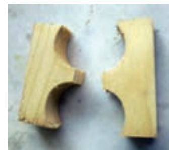
شکل ۸-۳ ج) نمونه آزمایش کشش عمود بر الیاف پس از شکسته شدن.
