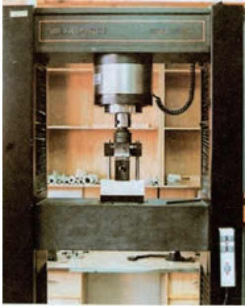
شکل ۹-۶- نحوه اندازه‌گیری مقاومت در برابر فشار عمود بر الیاف چوب
