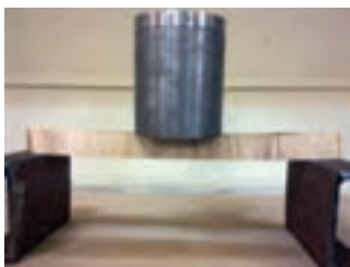
شکل ۷-۱۵- نمونه چوب صنوبر قرار داده شده تحت بار خمشی متمرکز، جهت الیاف عمود بر جهت طولی نمونه می‌باشند.
