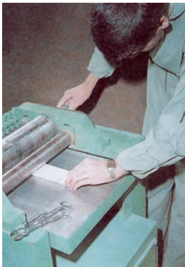
شکل ۶۶-۴- نحوه آزمایش تنظیم تیغه‌های گندگی با یک قطعه چوب
