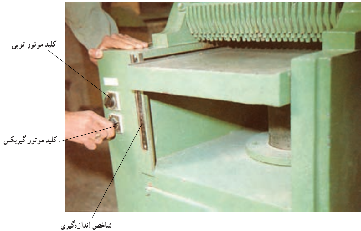
شکل ۴-۷۵- نحوه روشن کردن از کنار ماشین گندگی
