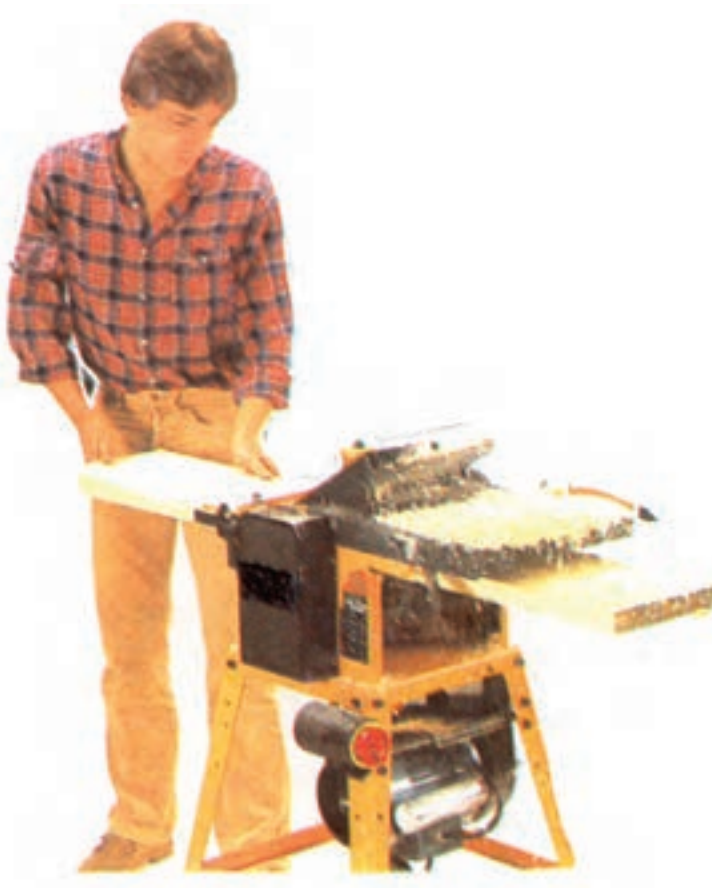
شکل ۸۱-۴-۱ - طریقه گندگی کردن صفحات بلند
