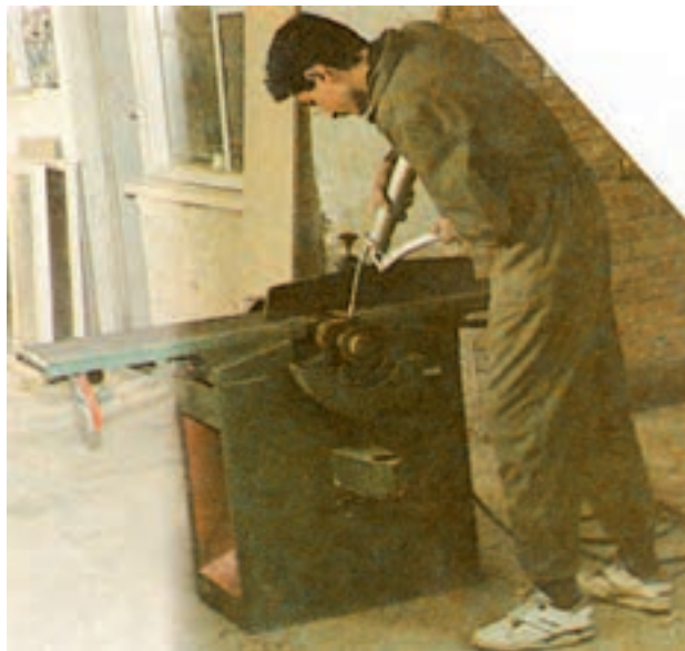
شکل ۱۸-۴- گریسکاری یاتاقان توپی رنده به وسیله گریس پمپ
