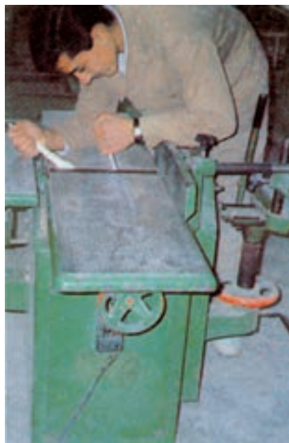
شکل ۲۴-۴- هنرجوی هنرستان ابوریحان کرج در حال سفت کردن تیغه رنده یک ماشین سه کاره.
