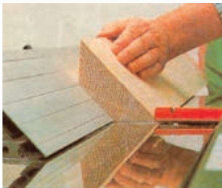
شکل ۴-۴۴- دو طرف چوب با زاویه ۴۵ درجه رندیده شده
