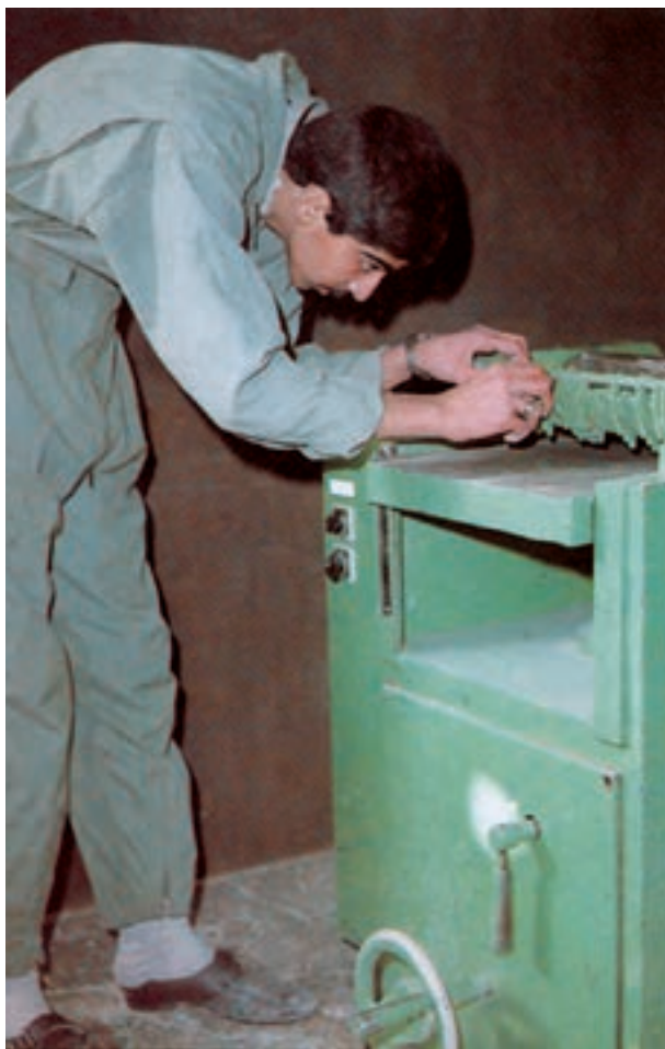
شکل ۴-۷۰- نحوه بررسی شانه فلزی حفاظت کننده ماشین
