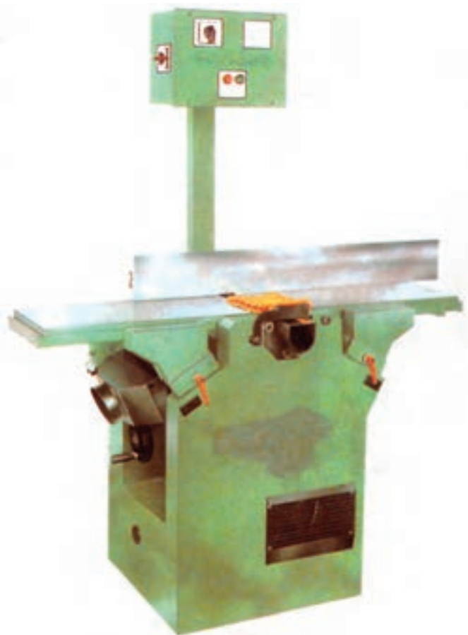
شکل ۴-۳۵- صحت ظاهری ماشین رنده را کنترل کنید.
