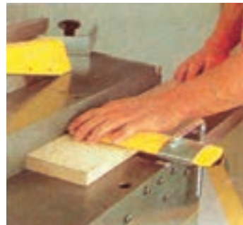
شکل ۴-۴۲- چوب از زیر حفاظ عبور داده شده
