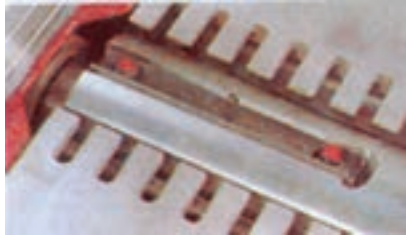
شکل ۴-۳- لبه‌شانه‌ای صفحات ماشین رنده برای تقلیل صدا.
