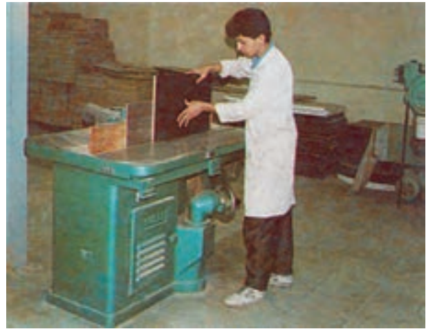
شکل ۴-۲- هنرجوی هنرستان پارس الکتریک تهران در حال رندیدن قطعه نئوپان برای ساخت کابینت.
