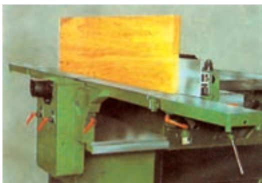
شکل ۲۶-۴- وضعیت چوب پس از تنظیم گونیای ۹۰ درجه.
