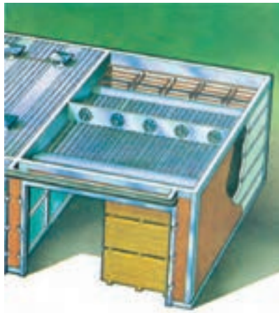
شکل ۵-۳- کویل‌های حرارتی در یک کوره
