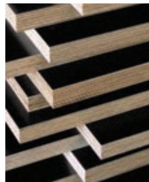
شکل ۱-۵- پوشش مواد عایق در تخته‌لایی
