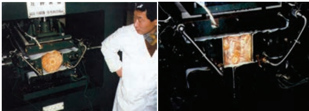
شکل ۲-۵ و ۳-۵ نشان دهنده پرس چوب طبیعی (ماسیو) برای کاهش حجم و افزایش جرم مخصوص در آزمایشگاه
