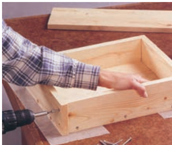
شکل ۲۲- اتصال جعبه با پیچ
