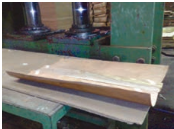
شکل ۱۳- ساخت کلاف طبقه
