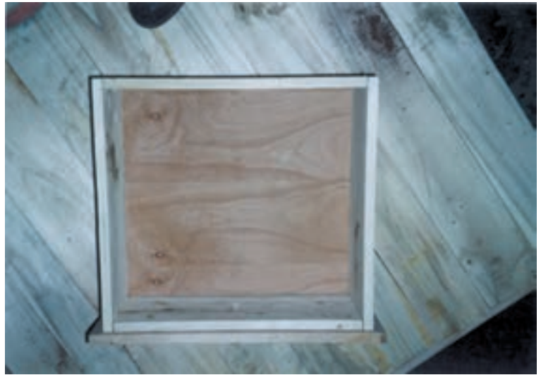
شکل ۲۴- اتصال در جعبه‌ی بیرونی بر روی جعبه‌ی داخلی به کمک چسب و پیچ
