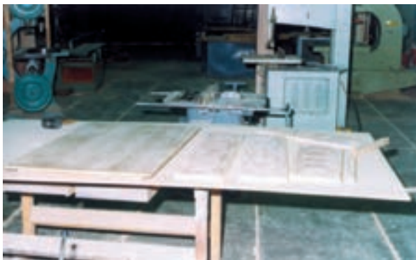
شکل ۱۱- مونتاژ کلاف بدنه
