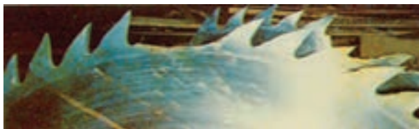
شکل ۱۳-۳ تیغه از با دندانهای شکسته
