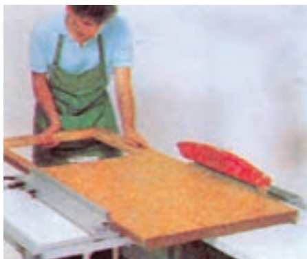
شکل ۳-۴۳- نحوه‌ی برش لبه صفحات عریض
