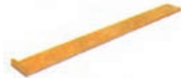
شکل ۳-۵۰- شابلون برای برش‌های طولی لبه صفحات بلند با ارّه گرد
