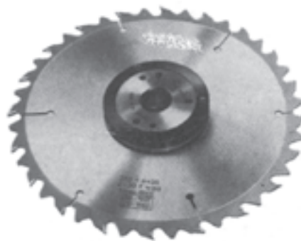
شکل ۳-۵۵- تیغه ارّه لنگ با واشر تنظیم‌پذیر
