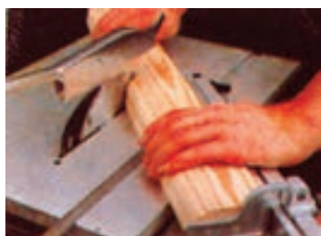
شکل ۳-۶۴- برش عرضی زاویه دار چوب پروفیل خورده
