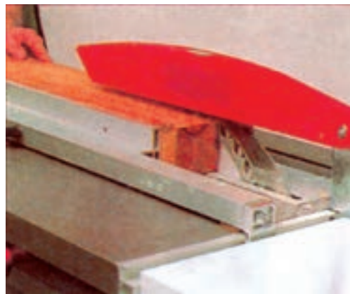
شکل ۳-۷۲- قطع طولی چوب با اژه گرد
