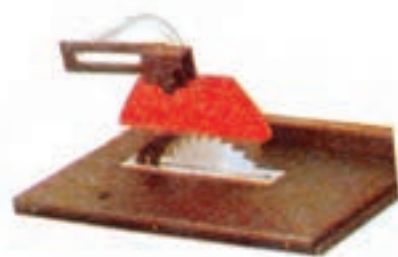
شکل ۳-۳۰- حفاظ روی پایه جداگانه است.
