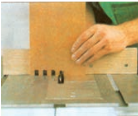
شکل ۳-۵۴- ایجاد اتصال انگشتی با ارّه لنگ
