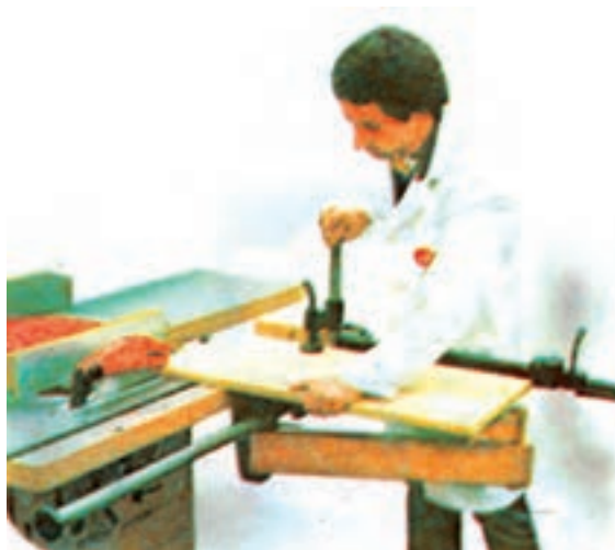
شکل ۳۷-۳- ماشین اره گرد میزی با میز متحرک کشویی
