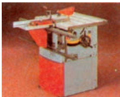
شکل ۳-۷- ماشین با میز کشویی و صفحه کوچک
