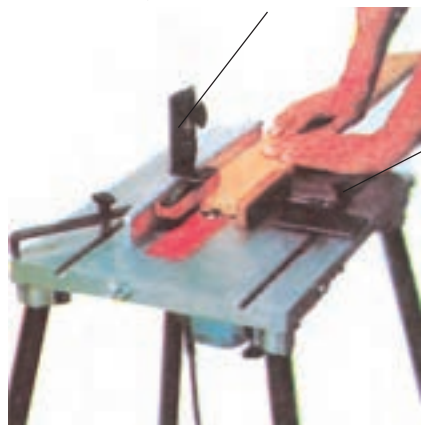
شکل ۳-۵۸- استفاده از قطعات حفاظتی
