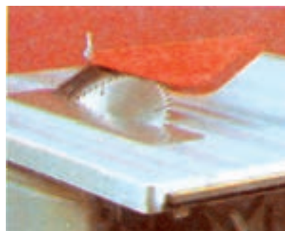
شکل ۳-۶- تیغ کج شونده تا ۴۵ درجه
