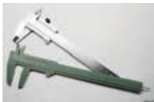
شکل ۵-۴- کولیس مکانیکی
