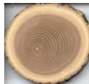
شکل ۴-۱۵- افزایش چوب تابستانه با افزایش دایره سالیانه در چوب نیمه بخش روزه‌ای پهن‌برگان در چوب بلوط
