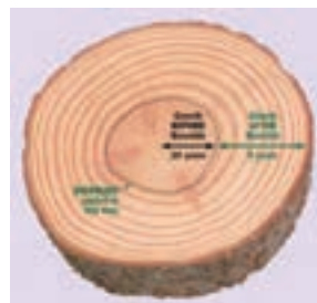
شکل ۴-۱۴- پهنای دایره سالیانه و نسبت چوب بهاره به تابستانه در چوب نراد
