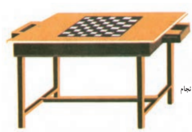
شکل ۱۵-۳- میز پینگ پنگ با صفحه هزار تکه چوبی به ابعاد: طول = ۲۷۴ سانتیمتر عرض = ۱۵۲/۵ سانتیمتر (طول تور) ارتفاع = ۷۶ سانتیمتر
