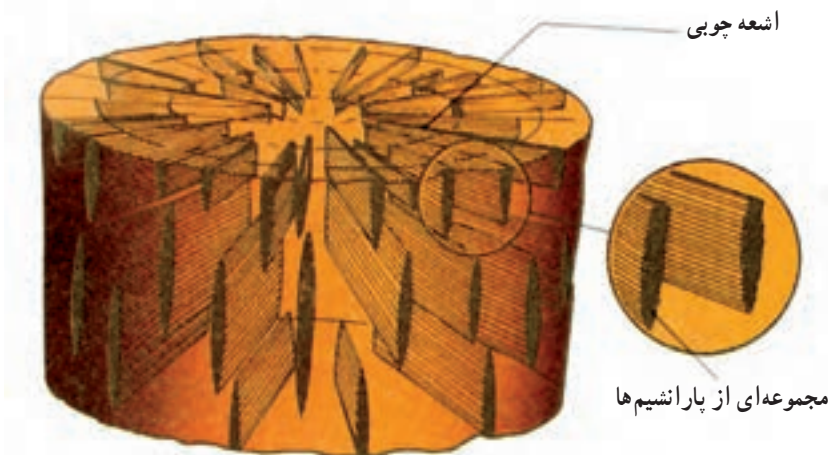
شکل ۵-۶- یک قطعه چوب که در آن موقعیت اشعه چوبی نشان داده شده است.
