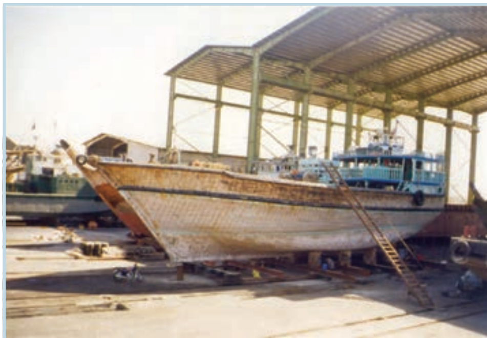
شکل ۱-۲ - نمونه‌ای از شناور چوبی در مرحله‌ی پایانی ساخت
