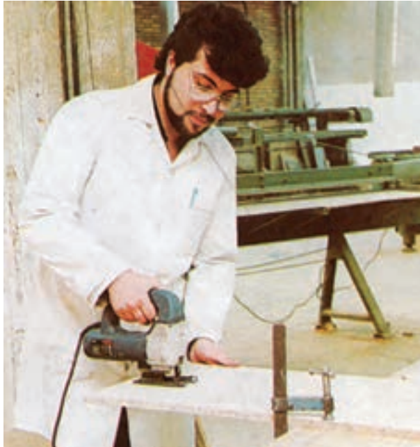
شکل ۲-۷- نحوه ثابت کردن قطعات بزرگ روی میز کار برای برشکاری
