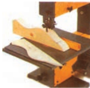
شکل ۲-۵۷- استفاده از گونیا کشویی در برش مستقیم
