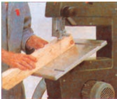
شکل ۲-۷۳- نحوه‌ی برش عرضی و زاویه‌دار چوب
