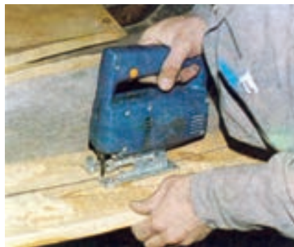
شکل ۱۷-۲- نحوه انجام برشکاری قطعات بزرگ بدون استفاده از گیره
