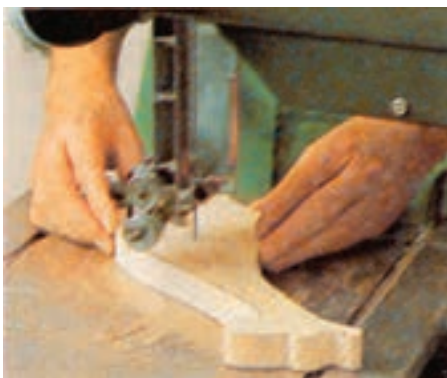
شکل 80-2 - با چه وسیله ای قوس بری می شود؟
