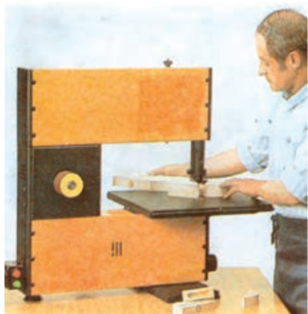
شکل ۲-۷۶- عملیات قوس‌بری صفحات
