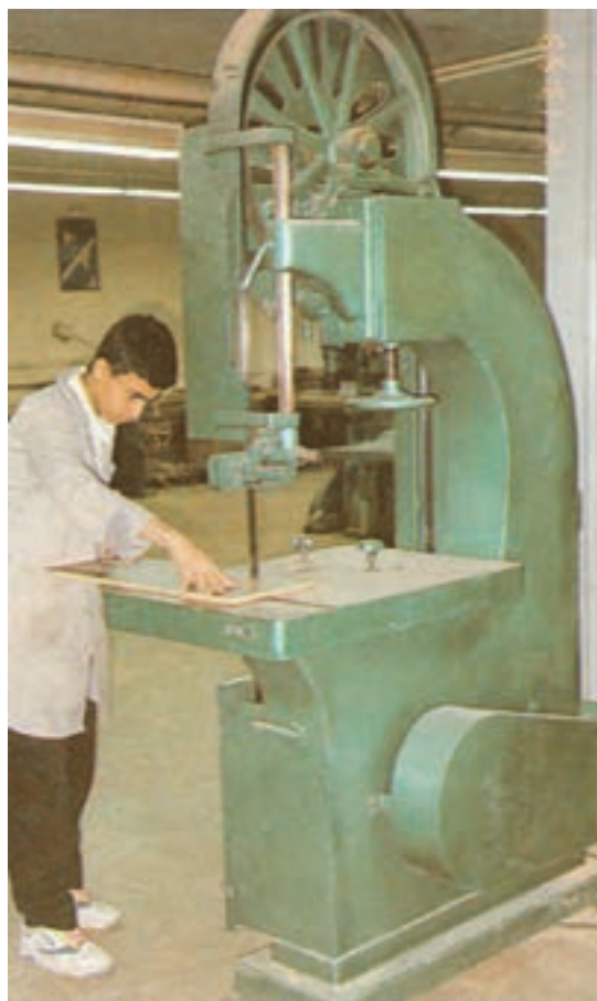
شکل ۲-۵۵ – قسمت فوقانی ماشین فاقد حفاظ کافی است.
