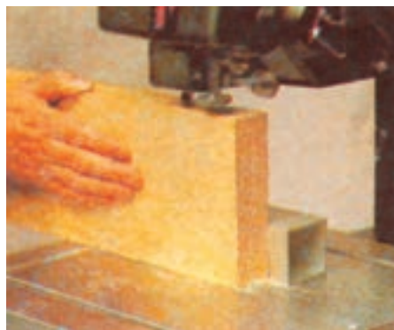
شکل ۲-۷۲- نحوه‌ی برش ضخامت چوب با استفاده از گونیا
