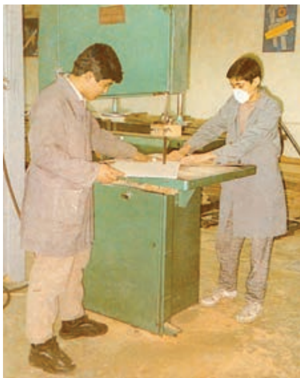
شکل ۶۰-۲- انجام عملیات برشکاری بدون استفاده از گونیا
