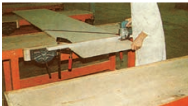
شکل ۲-۸- نحوه استفاده از خط کش بلند در برشکاری با اره عمودبر
