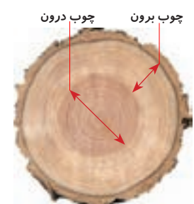
شکل ۱۷-۱ - چوب برون و چوب درون در مقطع گرده‌بینه چوب کاج
