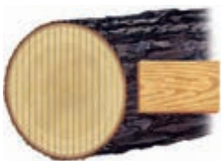
شکل ۱۳-۱ - برش مماسی از تبدیل گرده بینه
