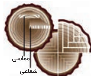
شکل ۱۴-۱ - برش شعاعی از تبدیل گرده‌بینه به الوار
