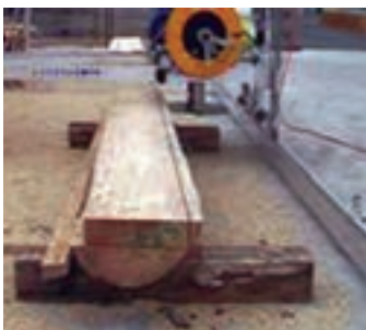
شکل ۱۲-۱ - تبدیل گرده بینه به الوار
