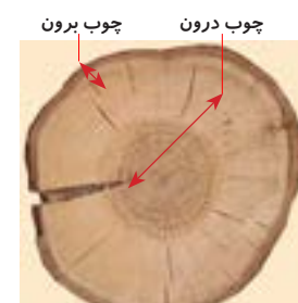
شکل ۱۶-۱ - چوب برون و چوب درون در مقطع گرده‌بینه چوب بلوط
