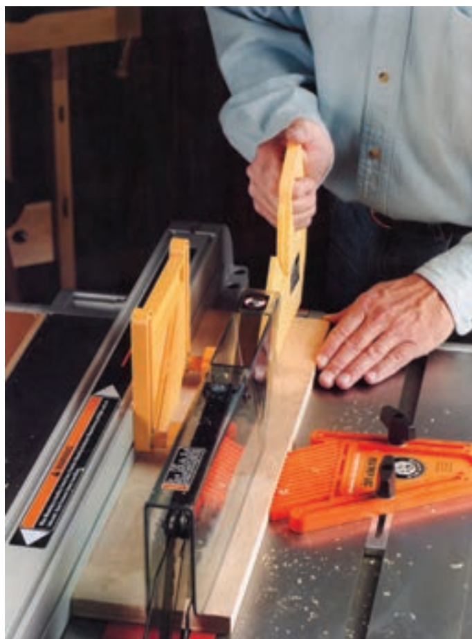
شکل ۲۹ – کار با ماشین اره گرد با استفاده کامل از حفاظ‌های ماشین و وسایل کمکی پیش‌دهنده چوب.
