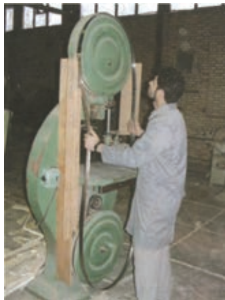
شکل ۱-۳۳- بعد از توقف کامل بایستی ارّه را پیاده کنید.
