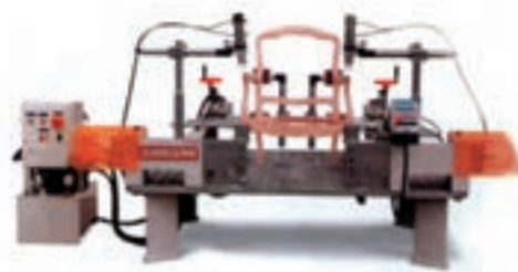
شکل ۶-۷ پرس مونتاز صندلی جهت میل و صندلی‌سازی
