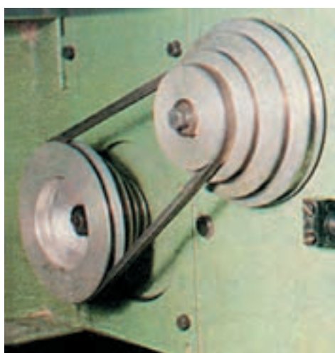
شکل ۳-۵- چرخ تسمه پله‌ای
