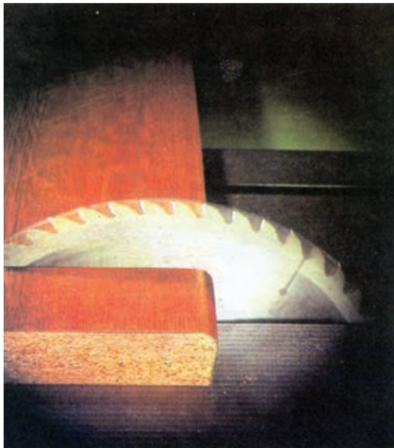
شکل ۳-۸- تیغه اره مجموعه‌ای
