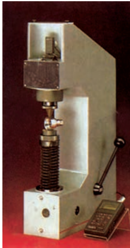
شکل ۸-۱۵ - سختی سنج با نمایشگر دیجیتالی
