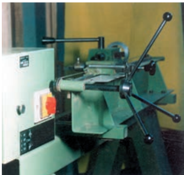
شکل ۵-۷- ماشین خراطی شابلون دار
