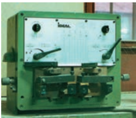
شکل ۱-۱۲- دستگاه جوش تیغه اره نواری
