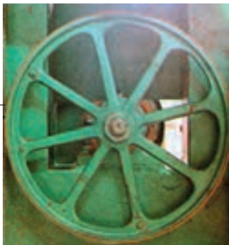
شکل ۴-۱- فلکه پایین اره نواری به همراه بانداز
