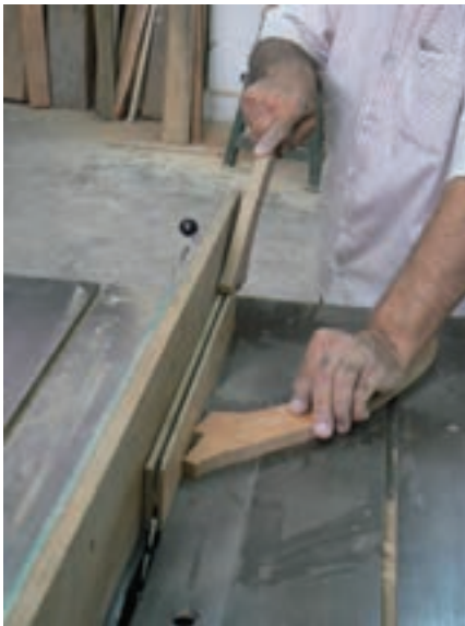
شکل ۱-۴۰- روش کنشکاف زدن
