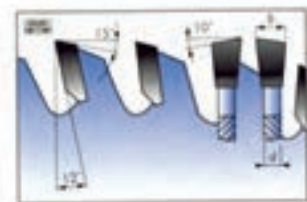
شکل ۱-۲۵ تیغه اره برشی پلاستیک و پلاستیک فشرده آهاردار
