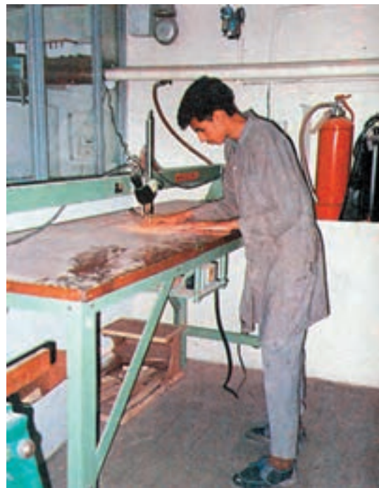
شکل ۱۷-۱- روش کار با اره مشبک‌بری
