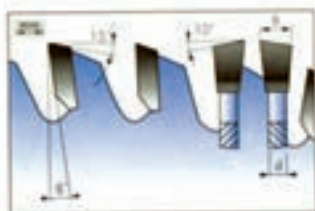
شکل ۱-۲۶ تیغه اره با دندان‌ها متراکم
