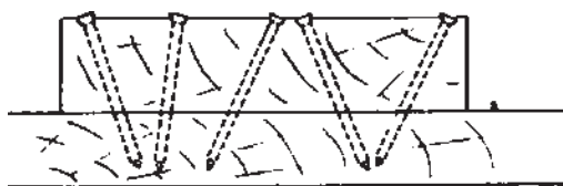
شکل ۵-۷۴- کوبیدن میخ به صورت دم چلچله
