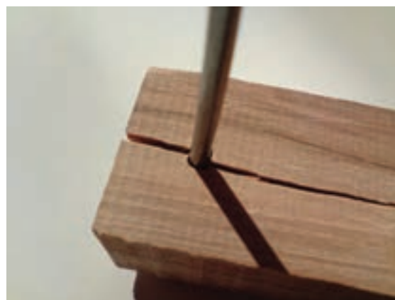
شکل ۵-۷۲- ترک خوردن راه الیاف
