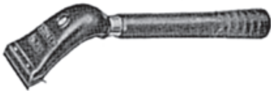
شکل ۴-۶- لیسسه اهرمی با تیغه دو لبه
