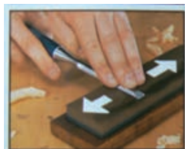
شکل ۵-۴۶ - طریقه تیز کردن مغار
