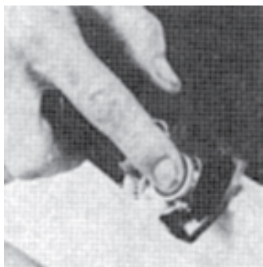
شکل ۱-۶ پرداخت لبه کار بصورت منحنی یا زاویه دار
