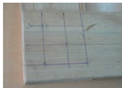
شکل ۵-۷۳- طریقه میخ‌کاری با فاصله مناسب
