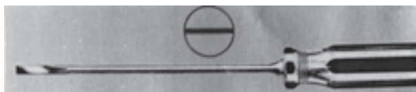
شکل ۷-۱۴ - آچار پیچ گوشتی دو سو (دوپهلو)
