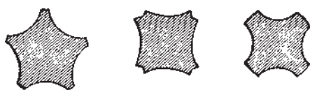
نمای مقطع تغییر شکل یافته میخ‌های سوئدی
