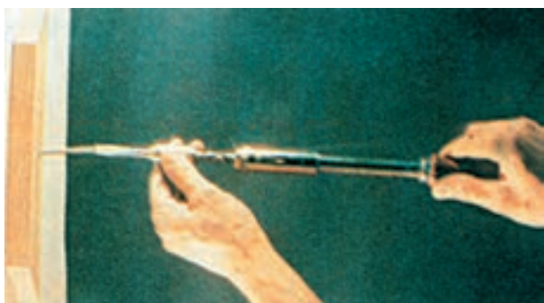
شکل ۱۷-۷- آچار پیچ گوشتی فشاری
