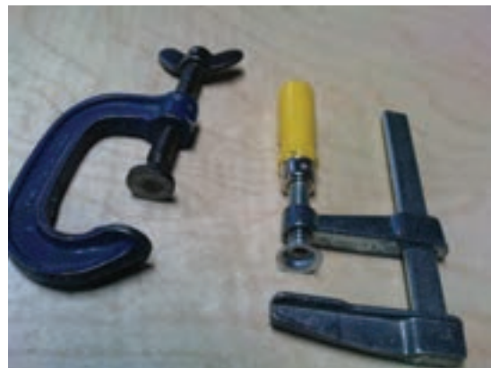
شکل ۸-۱- چند نمونه گیره‌دستی
