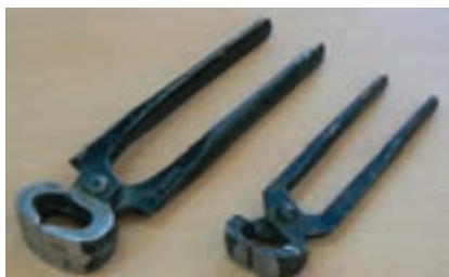
گازانبر از طول ۱۴۰ تا ۲۵۰ میلی متر شکل ۴۰-۵
