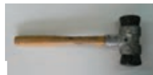
شکل ۳۵-۵ چکش لاستیکی استوانه ای
