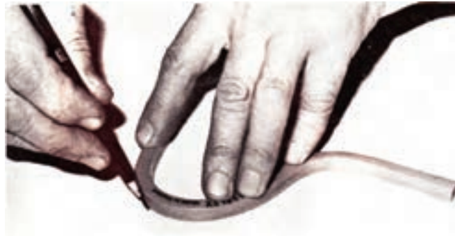
شکل ۲-۵۴- نمونه‌ی ترسیم خط منحنی توسط پیستوله‌ی ماری.
