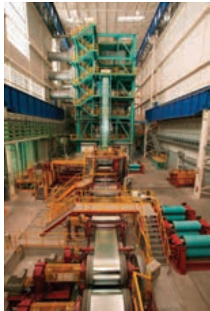
شکل ۸-۶. خط گالوانیزه کردن ورق و قوطی‌های فولادی
