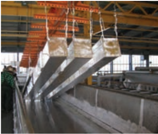
شکل ۸-۶. خط گالوانیزه کردن ورق و قوطی‌های فولادی
