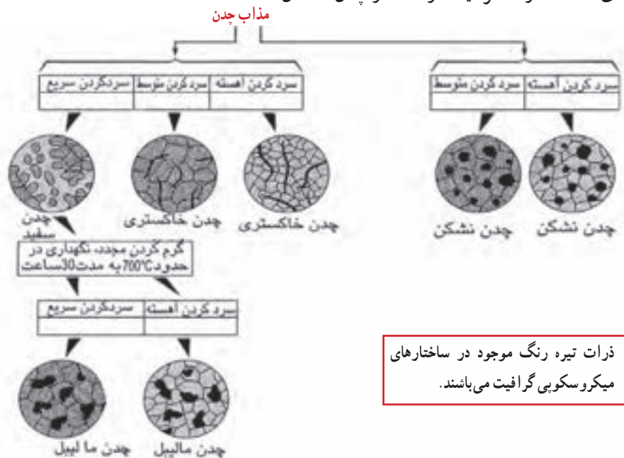
شکل ۸-۵- ساختار چدن‌ها و شکل ذرات گرافیت آزاد
