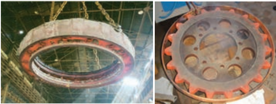
شکل ۳-۴- عملیات حرارتی سخت‌کاری سطح چرخ‌دنده بزرگ فولادی
