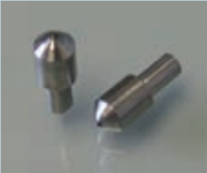
شکل ۲۱-۳- نمونه‌ای ابزار فرورونده جهت اندازه‌گیری سختی
