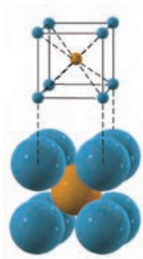
شکل ۳-۶- شبکه کریستالی مکعبی مرکز بر
