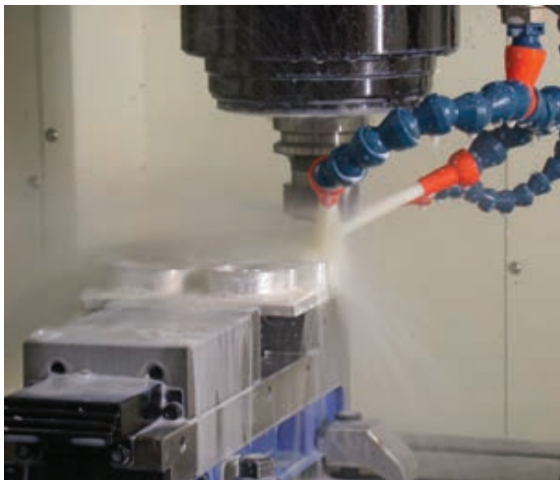
شکل ۳-۱۵ عملیات ماشین کاری قطعه فولادی
