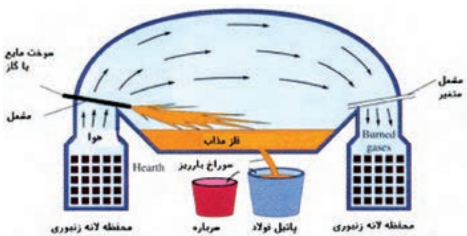
شکل ۱۳-۲ کوره زیمنس - مارتین که نسبت به روش توماس جدیدتر است.
