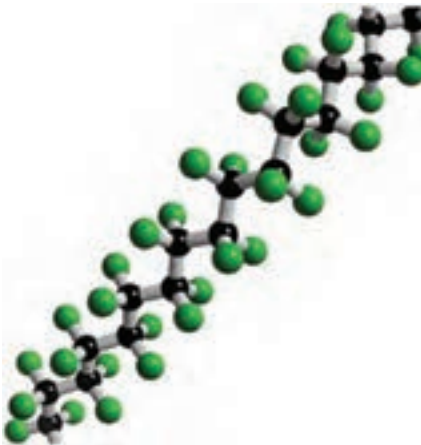
شکل ۱-۵- بخشی از یک مولکول پلیمری (تفلون)
