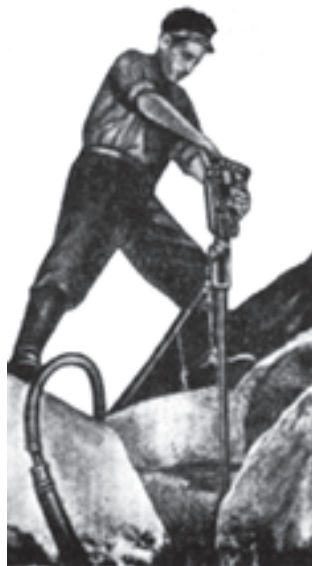
شکل ۹-۱۰- وضع ناپایدار کارگر کوه‌بر بر روی گرانیت
