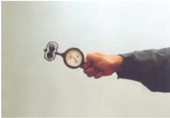
شکل ۸-۹ - طرز گرفتن هواسنج در مسیر جریان هوا
